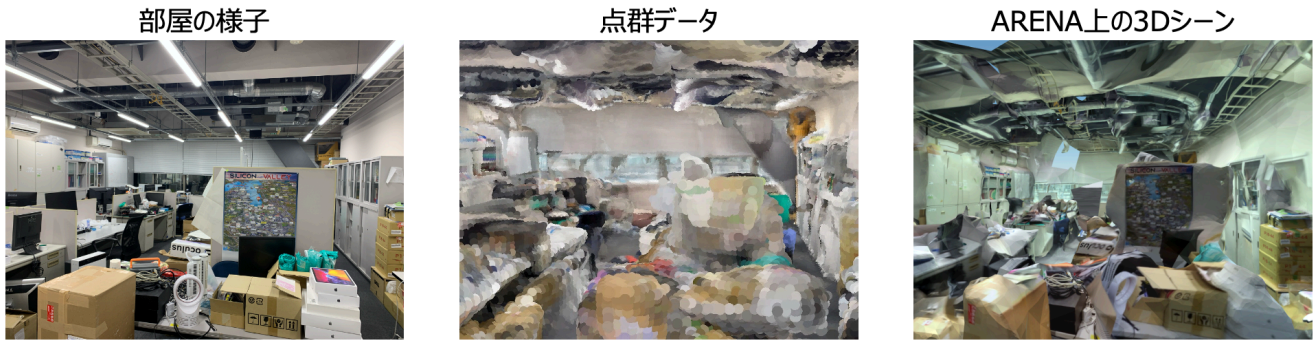
図 3 実際の部屋の様子 (左)・取得した点群データ (中央)・ARENA 上での 3D シーン (右)
