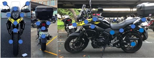
(b) マーカ配置パターン（二輪車の前面、背面、左側面）
