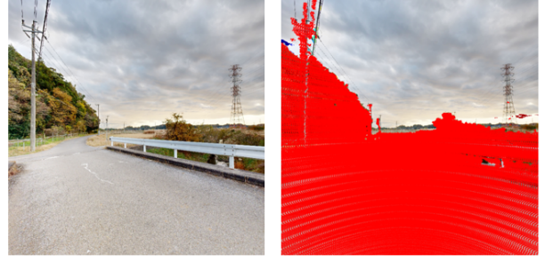
図2 変換式を活用して画像に点群を重ねた結果
