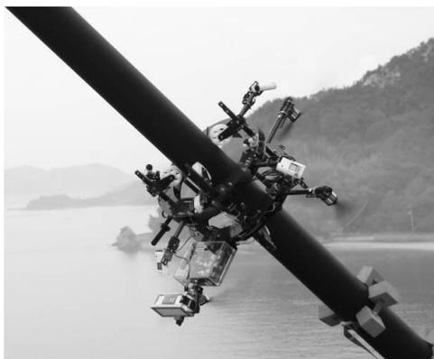
図-11 斜張橋ケーブル点検ロボット<sup>64)</sup>
