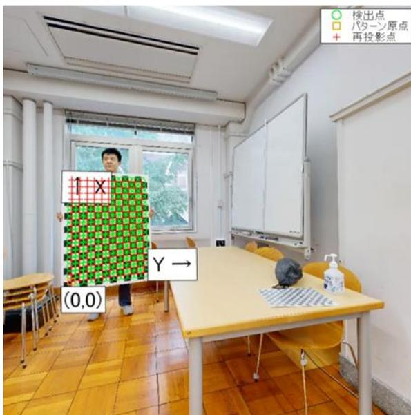
図-1 チェッカーボードを利用してカメラキャリブレーションを行っている様子。画像処理によりチェッカーボードのパターンの角などが自動的に検出されている。
